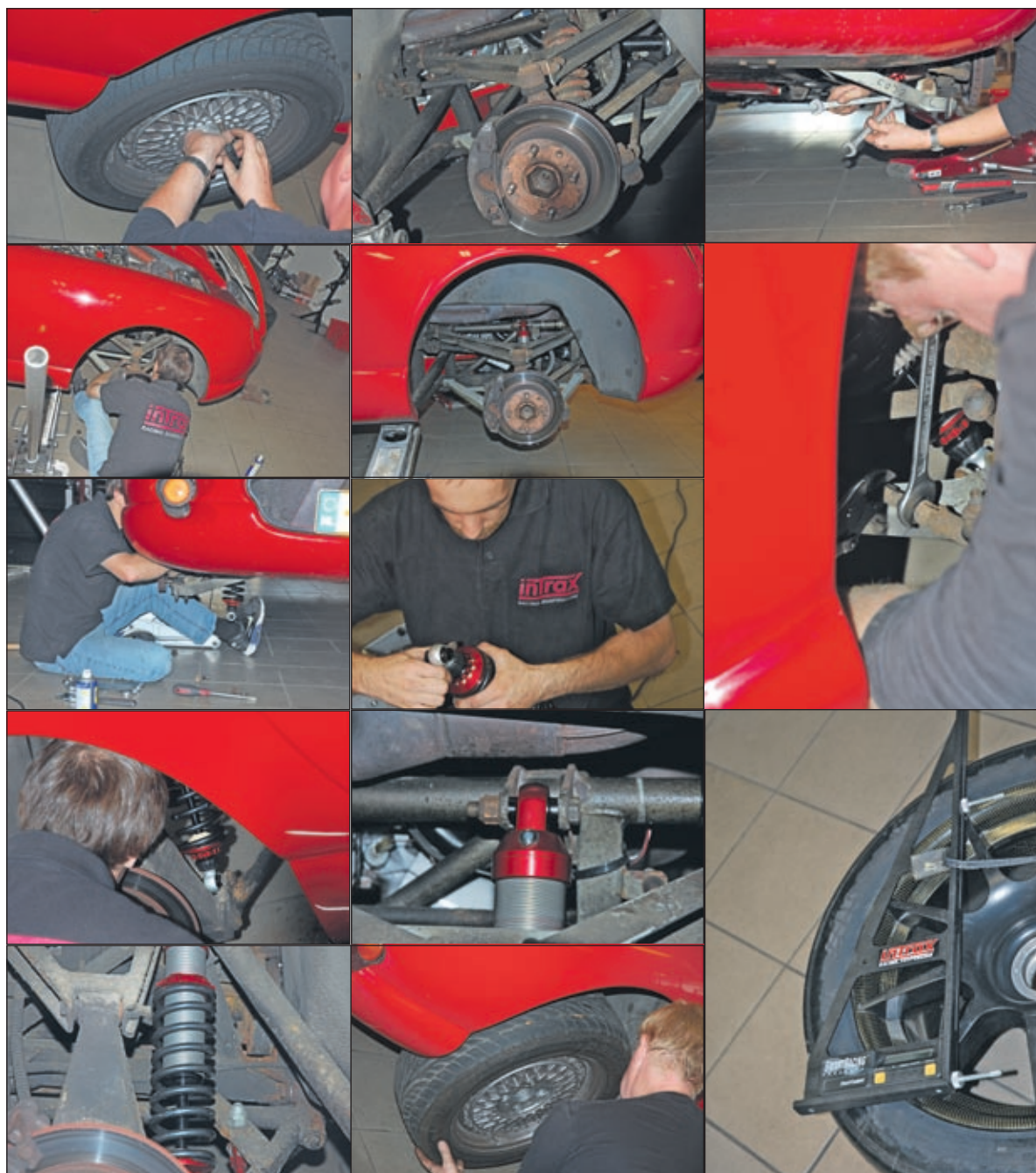
De Intrax dempers zijn aan de wielophanging bevestigd met 'uniballs' in plaats van de rubbers van de oude units. 'Dat verschil ga je straks goed merken', zeggen de mannen van Intrax. de montage verloopt voorspoedig; alleen de 'upright' rechtsachter zit iets in de weg.
